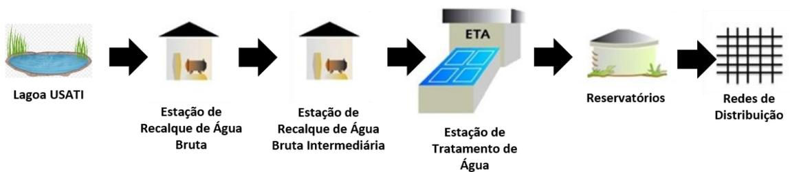
Para o abastecimento de água do município de Ilhota, o SAMAE tem capacidade de captar e produzir uma vazão que em função da demanda pode atingir 50 L/s, através da exploração dos 2 mananciais de superfície, sendo eles:
