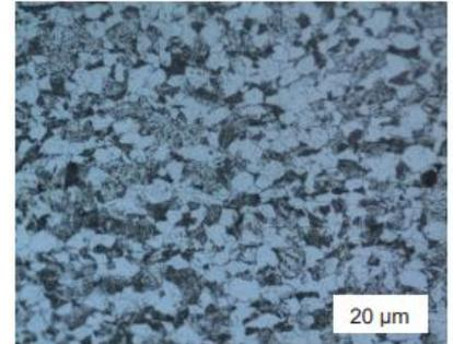
Na Figura 12, apresentada à seguir, metal de base como recebido da empresa fornecedora, observa-se uma estrutura com matriz ferrítica com grãos de perlita.
