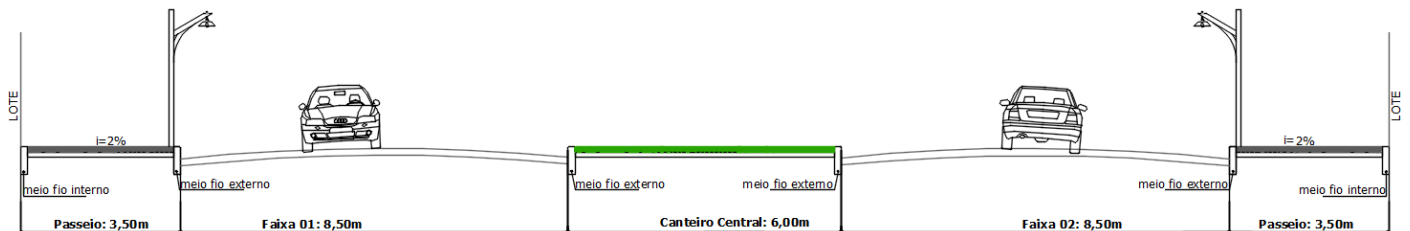
Figura 20 - Seção das ruas com 30 metros C
